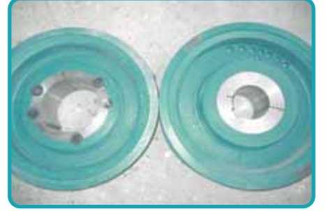
2 Speed on the Same Pulleys (52-58 m/sec) Aynı kasnakta 2 ayrı hız
