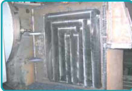
Machining of Motor Frame İşlenmiş Motor Sehpa
