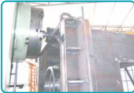
Machining of Bottom Frame İşlenmiş Alt Gövde, Kovan Yatakları
