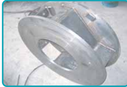
Dynamic Balance of Rotor Body (1600 rpm) Dinamik Balansı Alınmış Rotor (1600 rpm)
